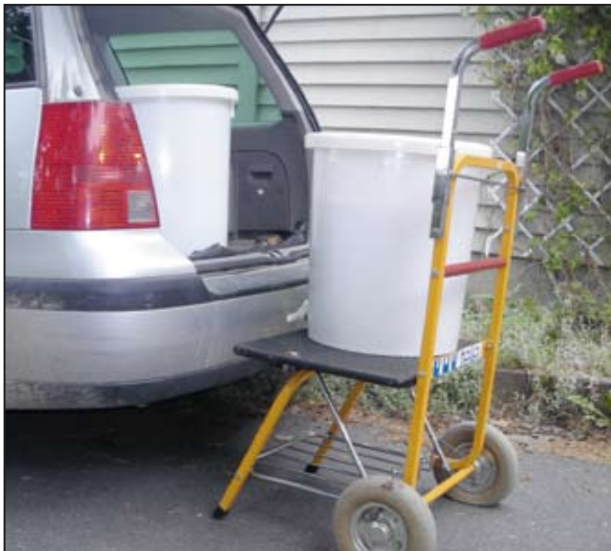
En paketkärra med flaket upphöjt gör det lättare att få in honungstunnan från bilen.
