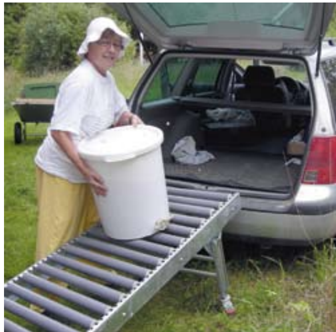
En rullbana gör det lätt att få in den tunga honungstunnan i bilen för hemtransport och burkning.
