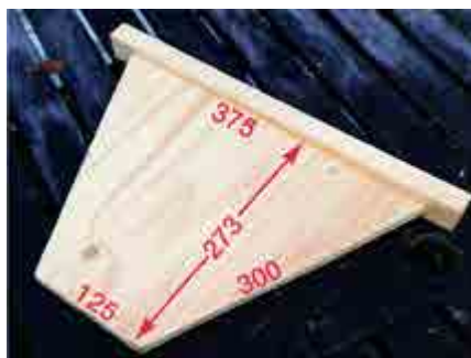
Avdelningslucka utgör mall för trågbygget.
