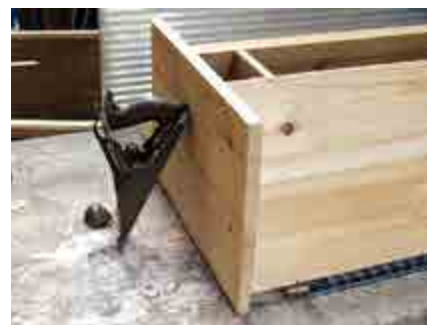
Därefter limmas och skruvas gavlarna fast.
