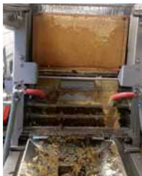
Avtäckningsmaskin. De uppvärmda knivarna skär bort täckvaxet som tillsammans med en del av honungen faller ner i vaxskruven.
