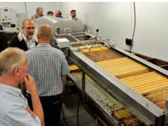
Ramarna transporteras vidare mot 64-ramarslungan via en conveyor.
