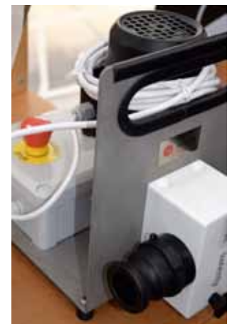
Swienty's har en nätt, prisvärd kugghjuls-pump till honung.
