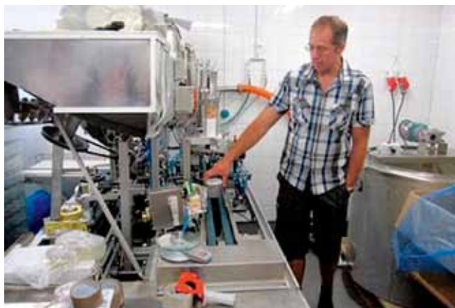
Tappmaskin. Automatisk upptappning för plastburkar på ena sidan och glasburkar på den andra.
