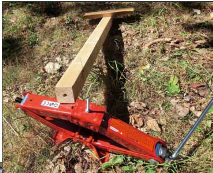
Två saxlyfter, två 5 x 5 cm i passande längd med klossar, samt säkrat med band.
