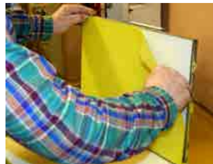
Den färdiga mellanväggen tas försiktigt loss från silikonformen.
