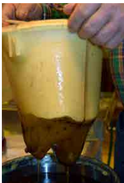
I vaxkastrullen finns en avklippt plasthink med nylonstrumpa som sil.
