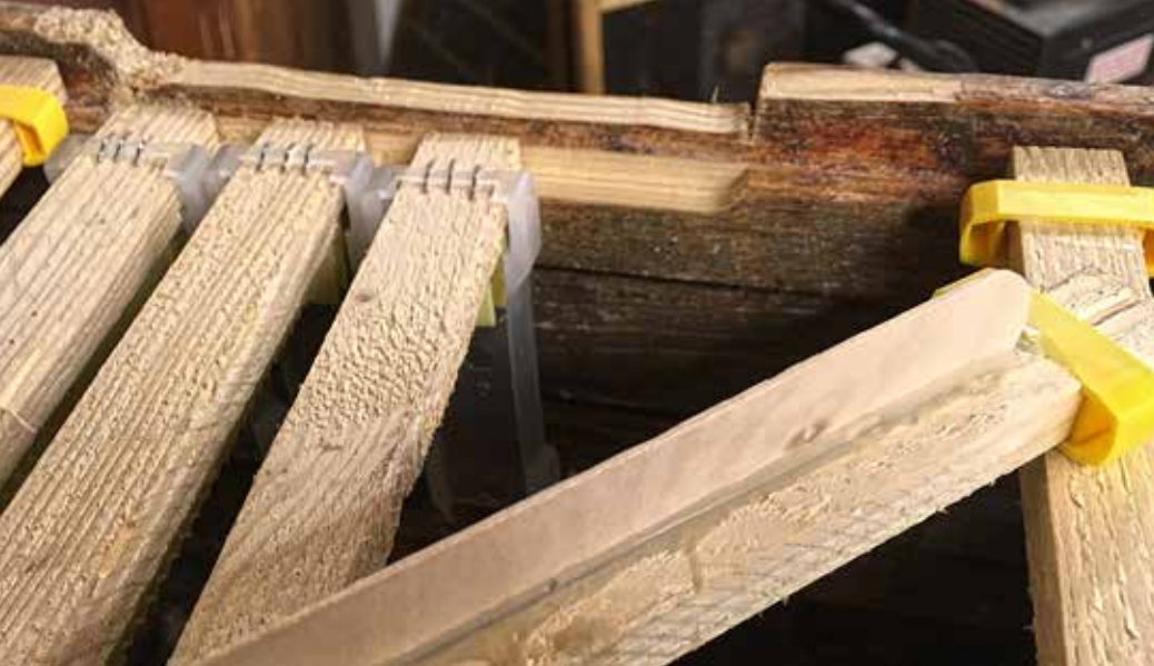
Bottenlådan försågs med toplister. Tungspatlar limmades fast på undersidan i ett spår och penslades med flytande vax.
