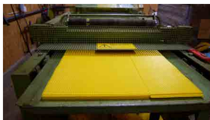
Vaxet stansas till rätt mått. Här dadant och \frac{3}{4} langstroth.
