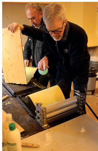
Bild 3: Bengt Nyman sprayar såpavatten på valsen för att vaxet inte ska fastna.
