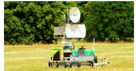
Bild 3. Mobil radaranläggning (harmonic radar tracking) för mottagning av signaler av drönare som är försedda med sändare. Foto: JOSEPH WOODGATE
