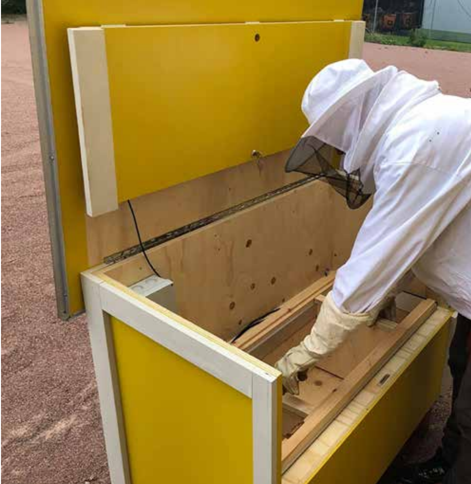
I Smålandskupan skymtar den grå plastlådan med styrenheten, själva "hjärnan" i systemet. Den samlar informationen från sensorerna inne i kupan, som vågen i botten, tillsammans med mätdata från temperatur-, fukt- och tryckmätare.
