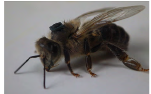
Chipet mäter 1 x 1 mm och sitter mellan vingarna. Det väger mindre än pollen-kornen som bina bär med sig.
