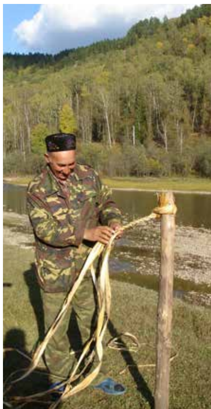
Kiram - Långa lindbastremсор flätas till kiram som kommer att tjänstgöra i flera decennier som livlina.
