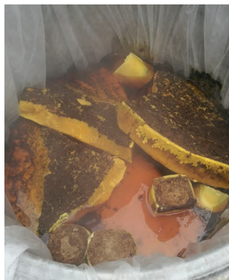
Finsilning i fiberduk för att få vaxet riktigt rent.
