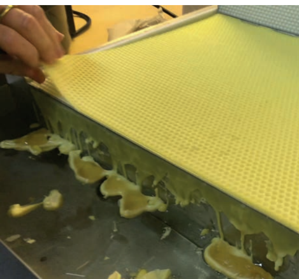
Finsilade vaxet gjuts till nya mellanväggar.
