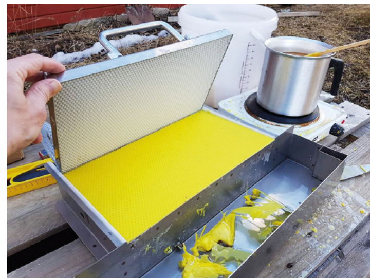
Gjutning av vax- mellanväggar. Foto: Pedro Blom
