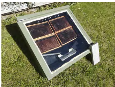
Tråget bockades och falsades på verkstad. Med dubbla lager ryms totalt åtta ramar.
