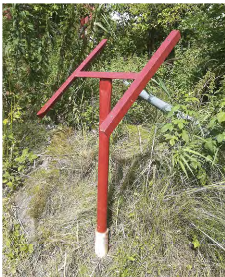
Stativet ser ut som ett stort notställ. Tegelröret ger stadga.
